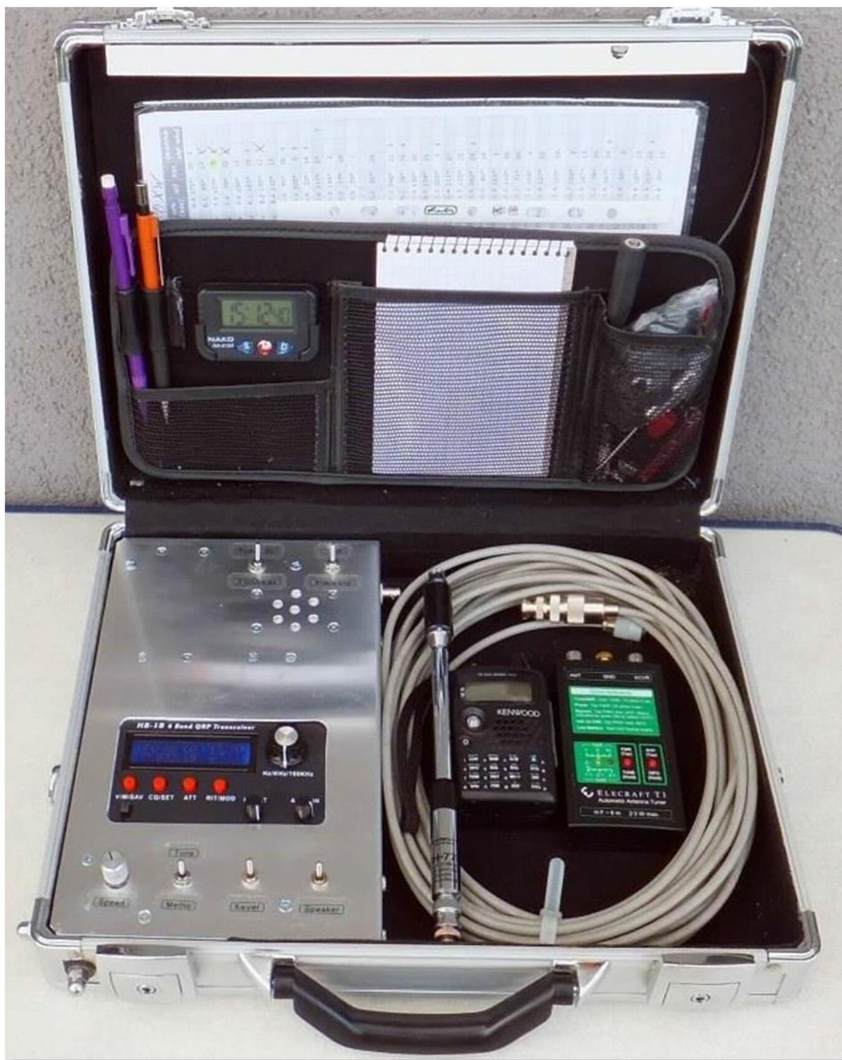
Mit diesem Wissen und dem Funkgepäck, bestehend aus dem Koffer mit HB-1B [80m bis 20m CW mit 5W], Automatiktuner T-1 und 10m-GFK-Teleskopmast als Vertikalantenne + max. 2 Radials für Kurzwelle und dem TH-F7E mit aufgesteckter Teleskopantenne RH- 770 für 2m und 70cm FM, ging es auf die über 600km lange Anreise.
