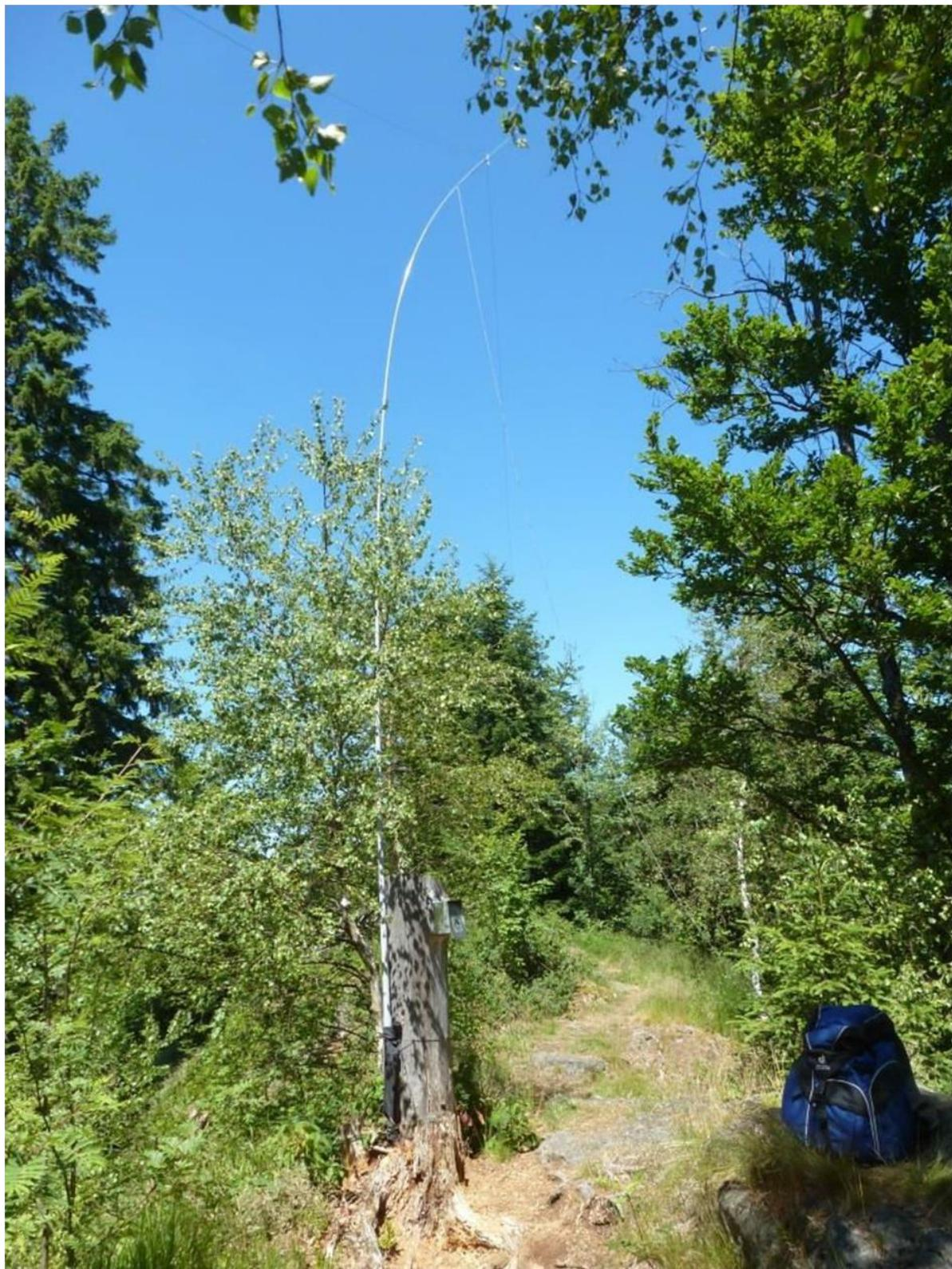
Zum Einsatz kam der FT817 mit Palm Mini Paddle und LiFePo-Akku, sowie ein linked Dipol für 40/30m am 10m-GFK-Mast von DX-Wire.
