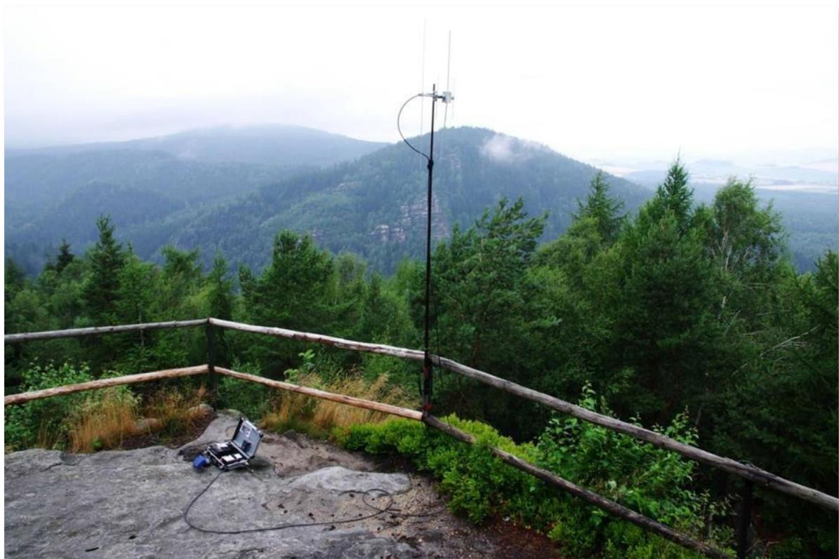
Die ist meist ausreichend fürs Zittauer und das Erzgebirge. Allerdings kommt da meist schon der Koffer mit Leistung zum Einsatz. Die mittlere Antenne hat 9 Elemente und ist etwa 1m lang. Die kommt dann auf "schwierigen" Bergen im Zittauer und im Erzgebirge (leicht westlich) zum Einsatz. Hier zum Beispiel in OK.
