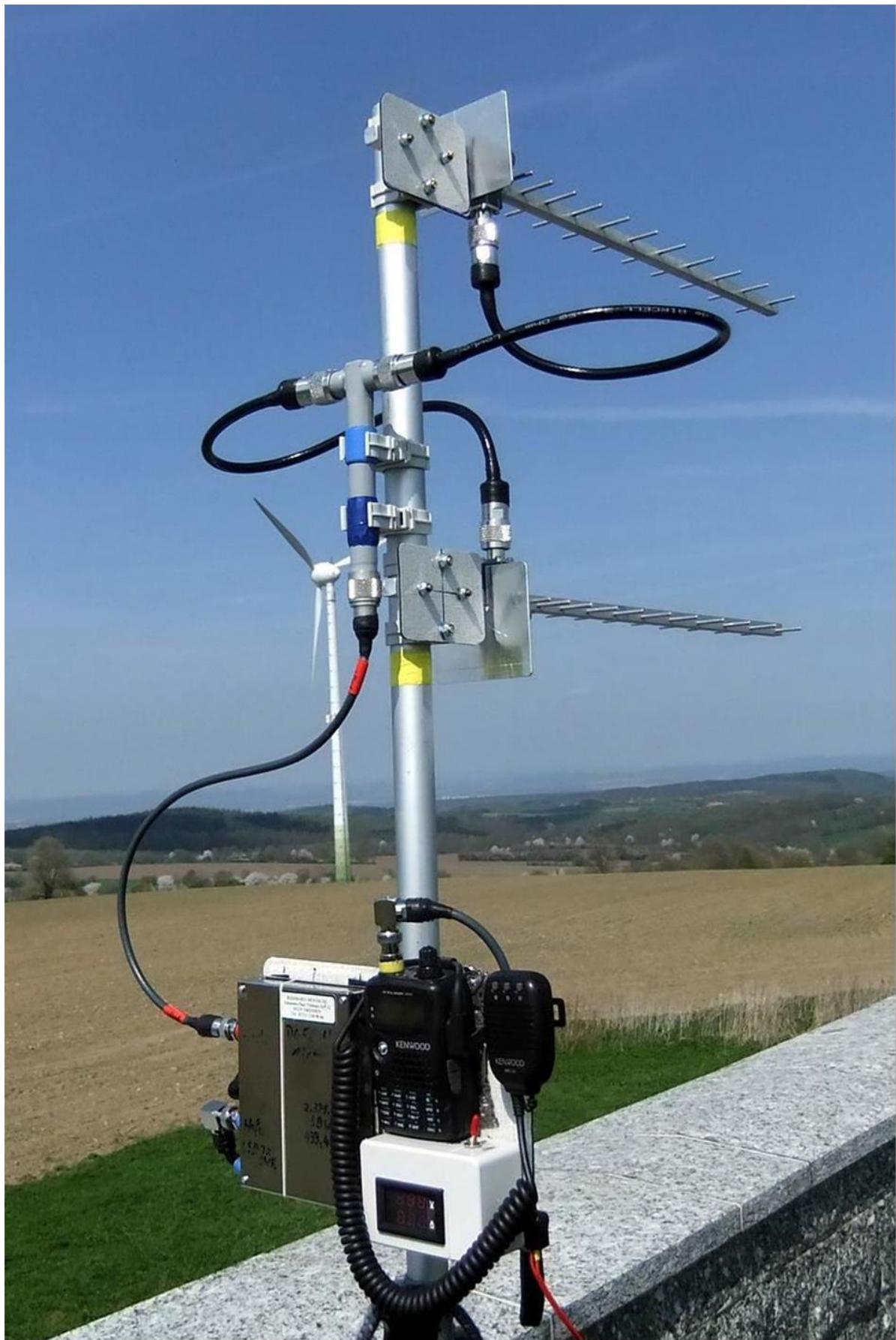
Sein letztes Experiment ist eine vertikal gestockte Yagi mit Anpasstopf. Die Praxis wird es zeigen...
