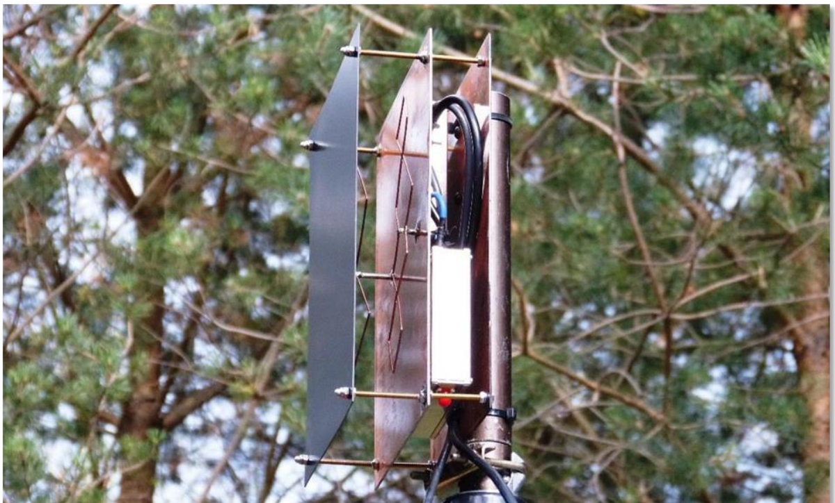
DJ5AM's Doppel-Quad für 23cm und Vierfach-Quad für 13cm mit gemeinsamen Reflektor
