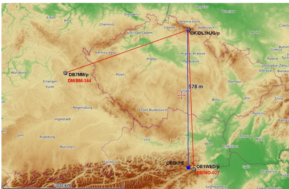
2m-FM ,DX' [50W + Yagi G=8dB auf H=3m]
