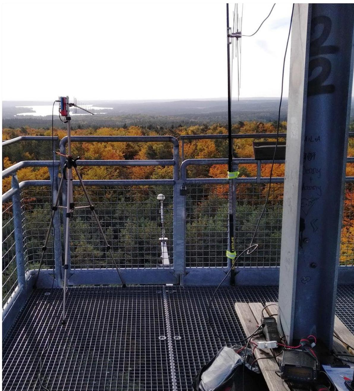
Mit dabei waren: Kenwood TM-D700 mit 50/40W, DK7ZB-Leichtbauyagi mit 4+5 Elementen und die neue schon im Erzgebirgsurlaub erfolgreich eingesetzte teilbare 23 cm-Yagi mit 13 dBd, LZ5HP-Transverter sowie ein LiFePo-Akku mit 10 Ah. Alt aber bewährt als Wanderfunke und Nachsetzer für 23 cm, das Standard C528.
