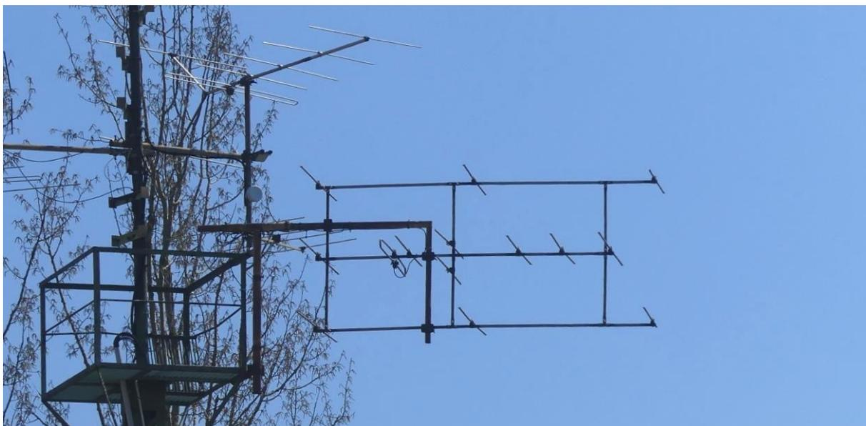
Sie sieht der Hochleistungs-Yagi, dem Nachbau der legendären Kathrein UKW-Antenne ähnlich. Diese war besonders hier im Raum Dresden sehr populär. Bei der wurden die Elemente mit schrägen Auslegern auch über und unter dem Boom montiert.
