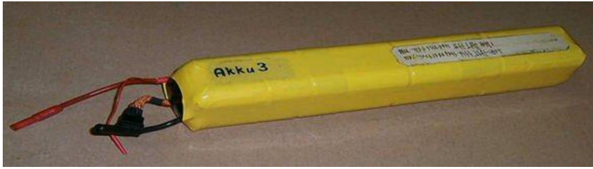
LiFOP04-Akku, 26,4V / 4,6A / ca. 1,2kg für einen Elektroheli
