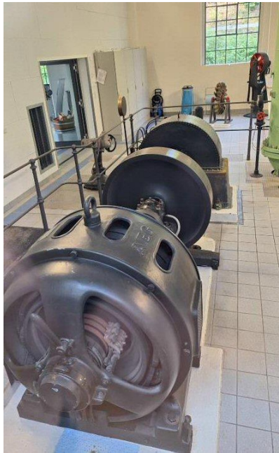
Eine der beiden Pelton Turbinen, eine Bj. 1899, die andere 1958.
