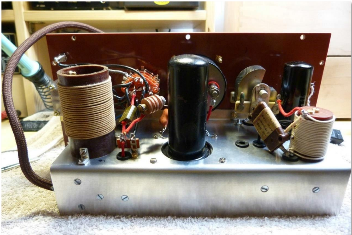
Sender mit Oszillatorstufe [rechts mit kleinerer Röhre 6V6] und PA-Stufe [links mit 6L6 Röhre in der Mitte]. Die Spulenkörper sind mit baumwollumsponnenem Draht bewickelt. Tränken mit Schellack sorgt für die Fixierung.
