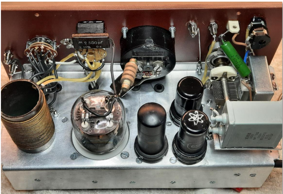
Oberseite des Chassis. Rechts Empfänger mit 2x 6SK7, Mitte Oszillatorröhre 6V6 in Stahlausführung und die Doppelanoden-Glasröhre 832A der PA, links die Spule des PA-Tankkreises.
