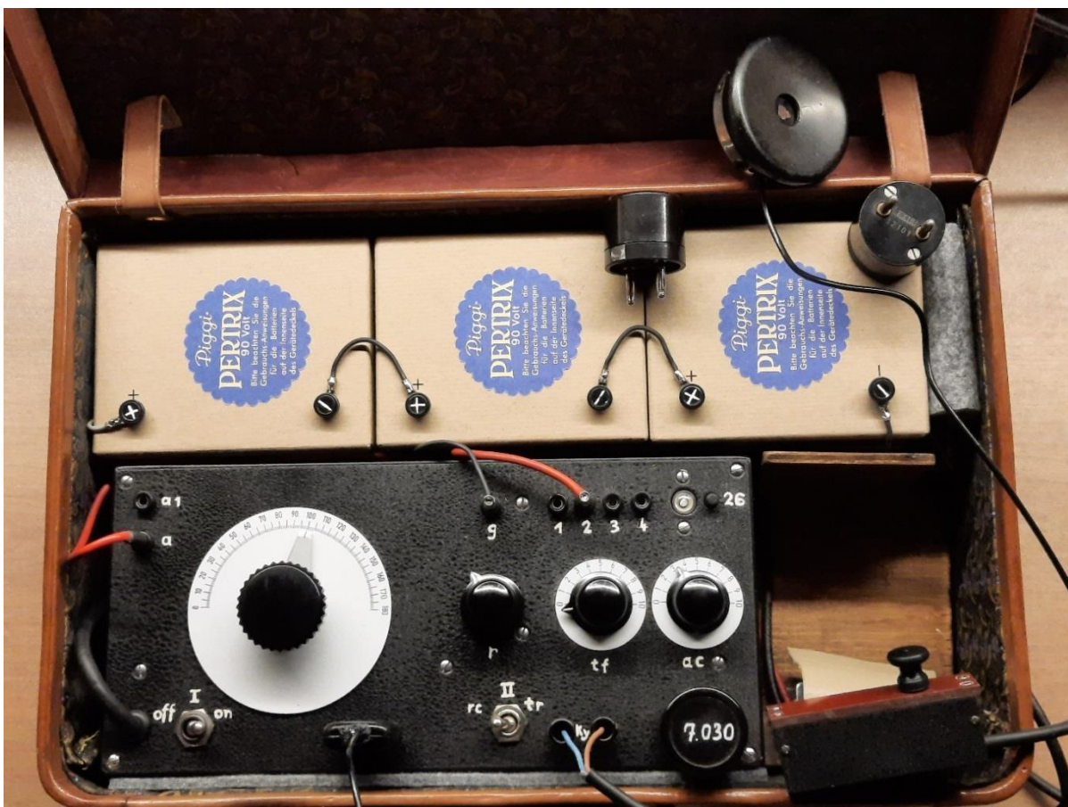
SE92/3 mit Sender und Empfänger in einem Gehäuse.
