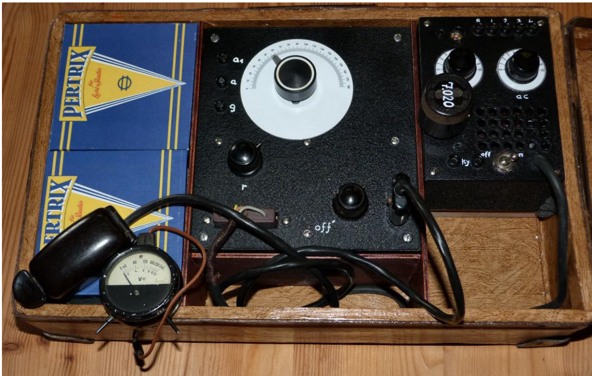
SE88/5 - Sender S88 mit einem auf Batterieröhren umgebauten Standardempfänger.
