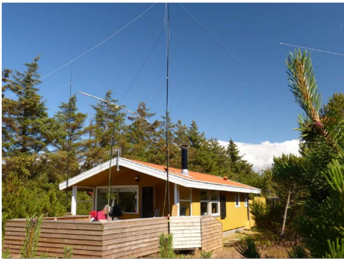
Wir beschränken uns auf eine 2 mal 20 Meter lange Zepp - Antenne, mit Hühnerleiter am Automatik-Tuner abgestimmt, einem Dipol für 18 MHz und einem Dipol für 50 MHz.
