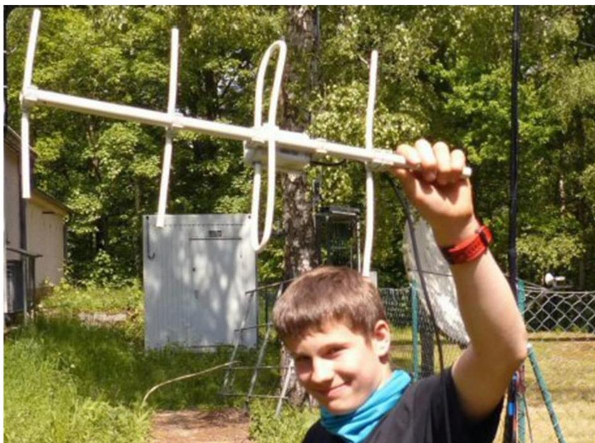
Hier noch mal im Detail. Die Elemente bestehen aus Kabelresten von TV-Antennenkabel auf einem Plasterrohr als Boom. So wird das Teil ultraleicht. Gefällt mir!
