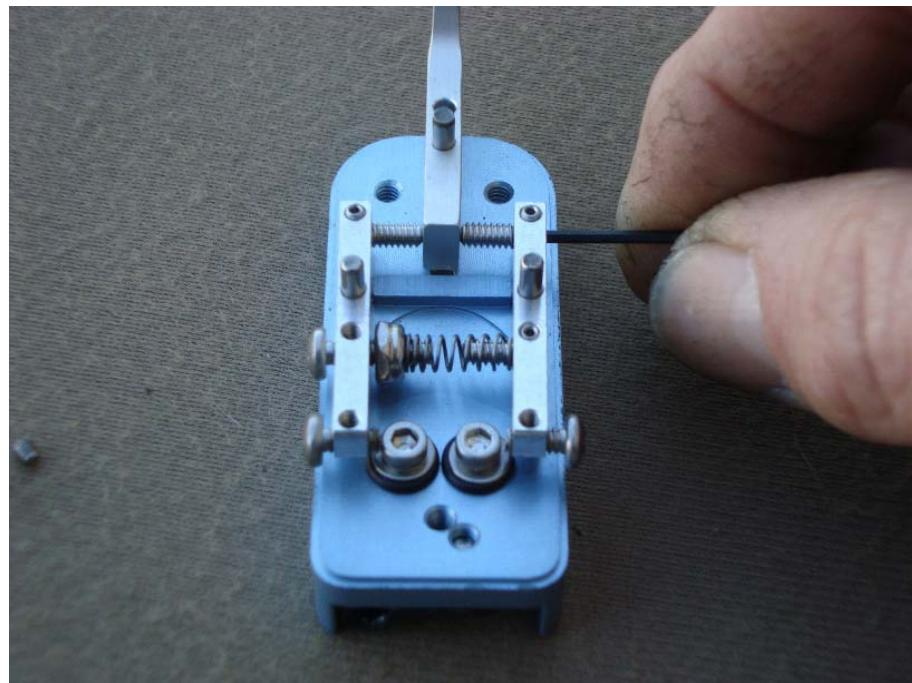
Mit einem Kreuzschlitzschraubendreher, drehst du die Kontaktsschrauben an die Innensechskantschraube bis sie sich fast berühren. Eine endgültige Einstellung des Kontaktabstandes und der Federkraftanpassung kann später erfolgen.
