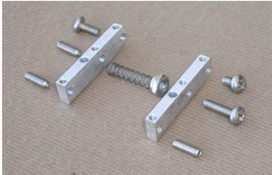
Jeder Hebel bekommt an einem Ende eine angeschliffene M4 x 1/4 Flachkopfschraube. Die Schrauben an den beiden angeschrägten Hebel Enden sind beim anfänglichen Reindrehen etwas schwergängiger. Stelle aber sicher, dass sie gut gefasst haben, bevor du den Schraubendreher benutzt.
