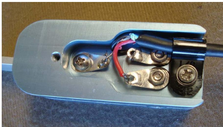
Eine M4 Gewindebohrung ist vorgesehen, um die Mini-B zu montieren. Sie passt auf den Schreibtisch, Klettband und Oberschenkelmontage. Das dazugehörige Equipment wird von American Morse Equipment angeboten.
