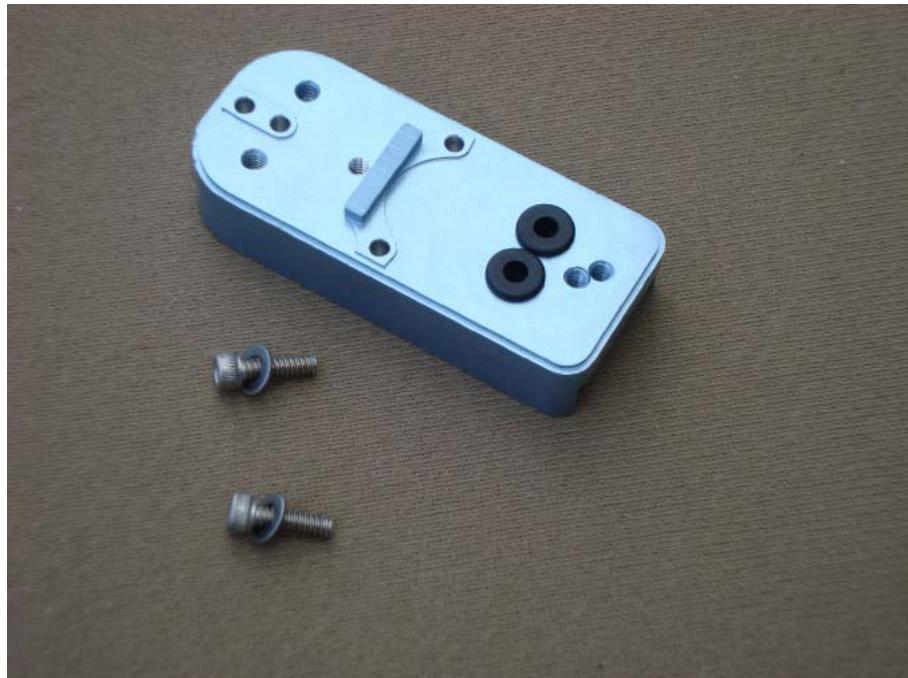
Lege eine Unterlegscheibe über jede der beiden Imbusschrauben. Stecke die Imbusschraube mit der Unterlegscheibe von oben durch die Isolierscheibe. Von unten schiebe eine der beschnittenen Lötösen über die Schraube, mit Ausrichtung auf das benachbarte Loch und sichere mit einer M4 Mutter.
