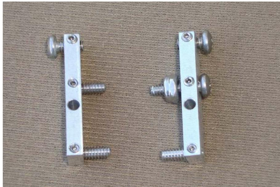
Stecke einen der Stiftbolzen durch das Loch auf der rechten Seite der Grundplatte und schiebe den rechten Hebel darüber. Der linke Hebel ist gleichzeitig mit der Feder zu montieren. Schiebe dazu den anderen Stiftbolzen in das gegenüberliegende Loch der Grundplatte und setze darauf den linken Hebel. Gleichzeitig schiebe die Feder über die Stellschraube, dann das andere Ende der Feder über die M4 x 7/16 Zylinderkopfschraube des rechten Hebels positionieren.
