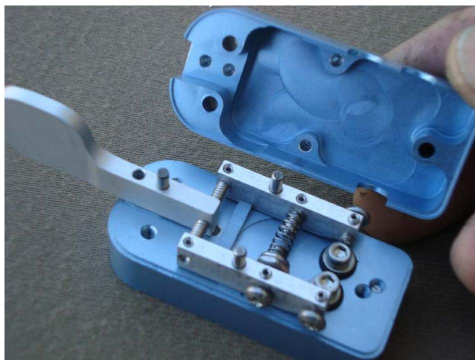
Jetzt folgt das sorgfältige Zusammenführen der oberen Abdeckung auf die Grundplatte. Die Löcher der Stiftbolzen im Deckel sind nur geringfügig größer [0,0002"] als die entsprechenden Löcher in der Grundplatte, was die Montage erleichtert und die Stifte bleiben an ihrer Position, auch wenn die obere Abdeckung entfernt wird. Drücke die Abdeckung mit deinen Fingern nach unten und platziere die drei Senkkopfschrauben in ihre jeweiligen Öffnungen.
