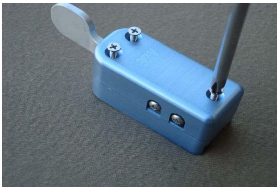
Verwende einen Kreuzschlitzschraubendreher um den Kontaktabstand und die Federkraft zu regulieren. Du kannst die Paddel Hebelverhältnisse jederzeit durch einfaches Entfernen der oberen Abdeckung und umsetzen das Paddel Stiftbolzens auf das andere Loch verändern. Nichts anderes wird sich ändern, wenn der Stiftbolzen neu positioniert wurde. Die Einstellung kann jederzeit mit einem Schraubendreher gemacht werden.
